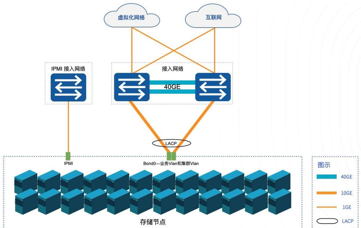
可采用 2 台万兆交换机堆叠, 承载存储集群的所有网络流量, 服务器使用 2 个接口绑定接入交换机 Trunk 接口, 通过在服务器操作系统内划分 Vlan (即子接口) 隔离业务网络和集群网络。如集群规模扩展至 45 台以上, 需要在上层增加核心层交换设备, 同时需要再增加一组接入交换机连接更多存储节点服务。
