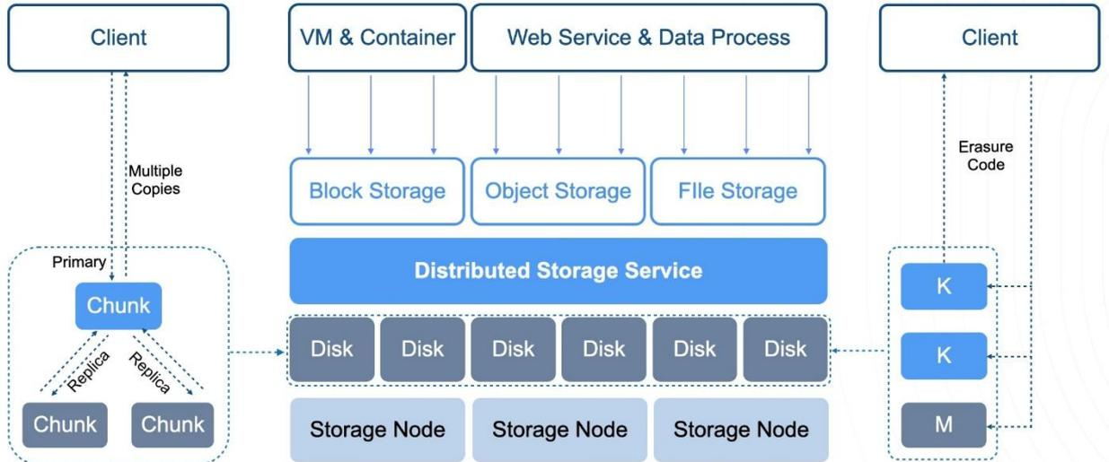
UCloudStor 支持存储池粒度的不同副本数量存储策略，副本数支持 2~6（一般推荐采用三副本并且进行强一致性验证，保障每一份数据的 3 份副本）， $2N+1$  节点情况下允许  $N$  个服务器损坏，系统仍能正常运行。通过系统的实时多副本技术，保证数据高可靠，可以根据用户需要设置数据副本数量和复制策略，把数据同时存在于多台服务器、多个机架之中，最大限度提高数据容灾能力。多副本存储策略具有以下优点：
