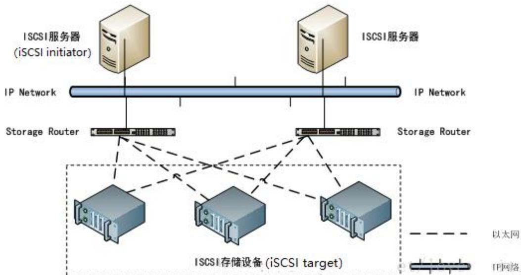
1) iSCSI Target 设备配置：在远程存储设备上配置一个 iSCSI Target，这是提供存储服务的设备。iSCSI Target 将通过网络提供存储卷或逻辑单元给主机系统。
