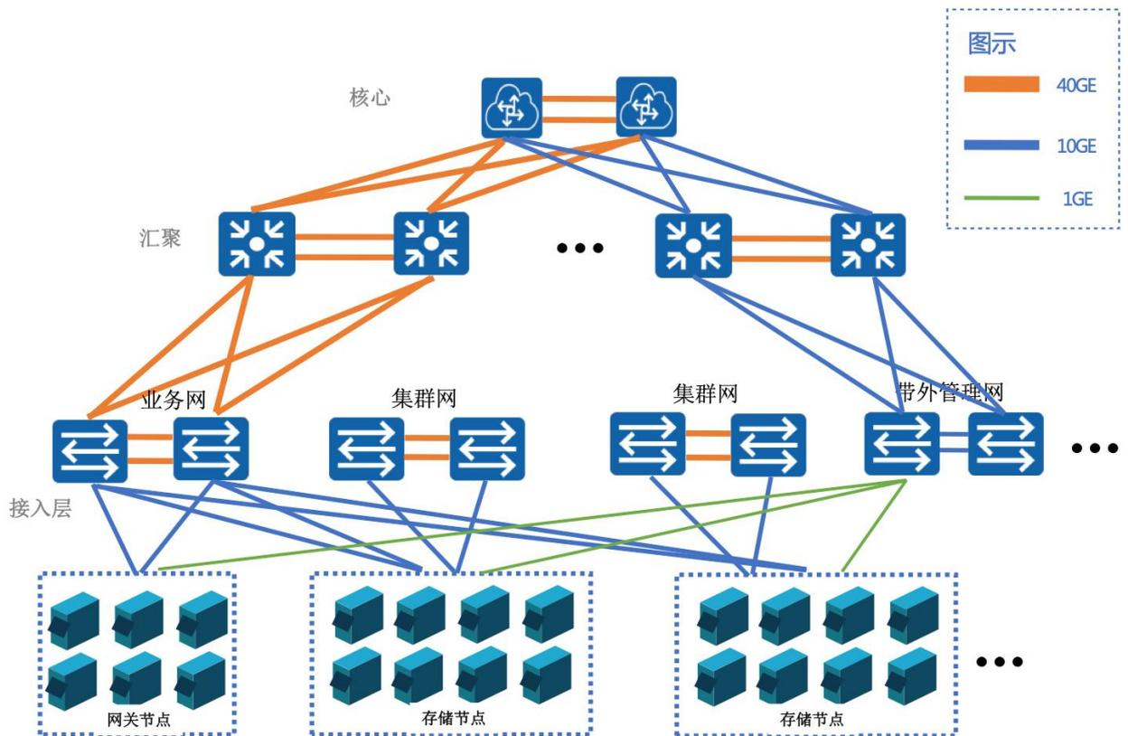
采用传统三层架构（接入-汇聚-核心）；接入交换机和汇聚交换机采用堆叠技术，保证带宽和冗余；
