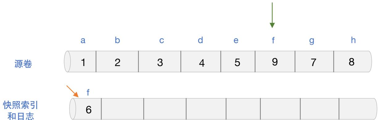
基于写时复制机制（COW），在创建快照时，存储系统会记录当前卷的元数据信息，并创建一个指向原始数据块的元数据映射表，当发生数据写入时，存储系统会先将要修改的数据块复制到新的位置（快照卷），然后新的位置上进行写入操作，这样，原始数据卷上的数据保持不变，而快照卷上的数据随着写入操作而改变。快照只存储修改的数据和元数据信息，因此在存储空间方面具有一定的节省效果。
