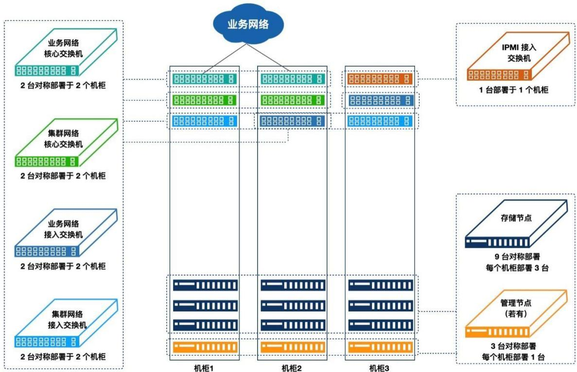
所有设备在机柜中对称部署，结合管理节点高可用及存储节点故障域实现机柜级冗余，单机柜掉电或故障不影响云平台业务。通常一个机柜可支撑 15 个 2U 节点，根据网络架构设计一组接入交换机支撑 45 个节点，即一组接入交换机支撑 3 个机柜。
