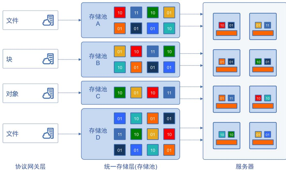
平台采用全分布式架构，所有组件都是对等的，可以分布部署在多个存储服务器上，没有单点故障和性能瓶颈。
