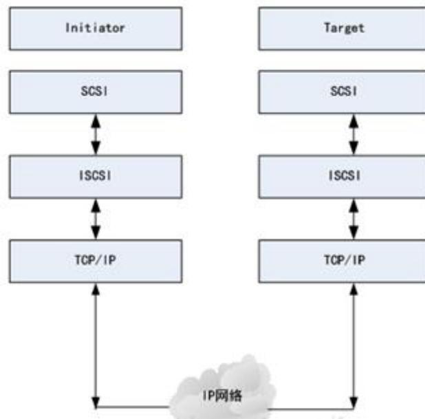
针对客户端通过 iSCSI 协议访问存储设备的场景，UStor 统一存储提供启动器组功能，可以将卷与 iSCSI 客户端进行映射，启动器组内的所有启动器（iSCSI 客户端 IQN）均可访问映射的卷，即通过不同的 IQN 创建多个启动器，多个启动器归属于某个启动组。
