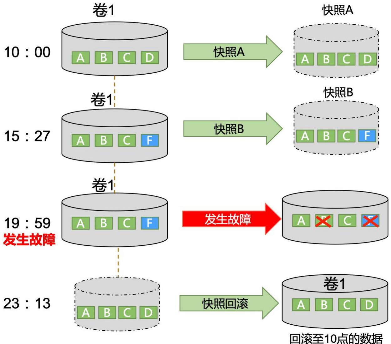
UStor 提供秒级快照机制，将用户的逻辑卷数据在某个时间点的状态保存下来，作为备份恢复数据之用。单卷最大快照个数达到 256 个。支持手动一次性快照和自动快照策略两种方式。
