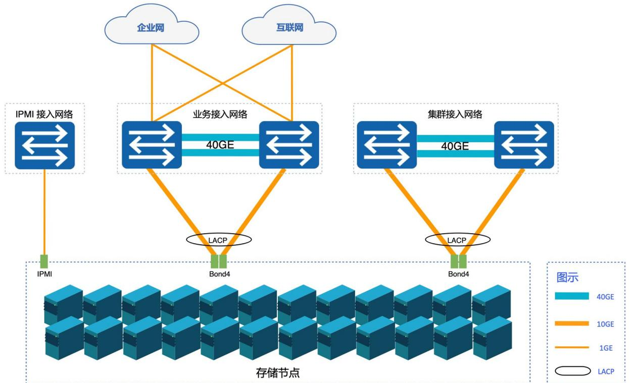
整个存储系统网络设计为集群接入 (ClusterNetwork) 和业务接入 (PublishNetwork) 两张网络区域, 分别承载集群内通信和对外业务通信, 两张网络在网络设备层面物理隔离。
