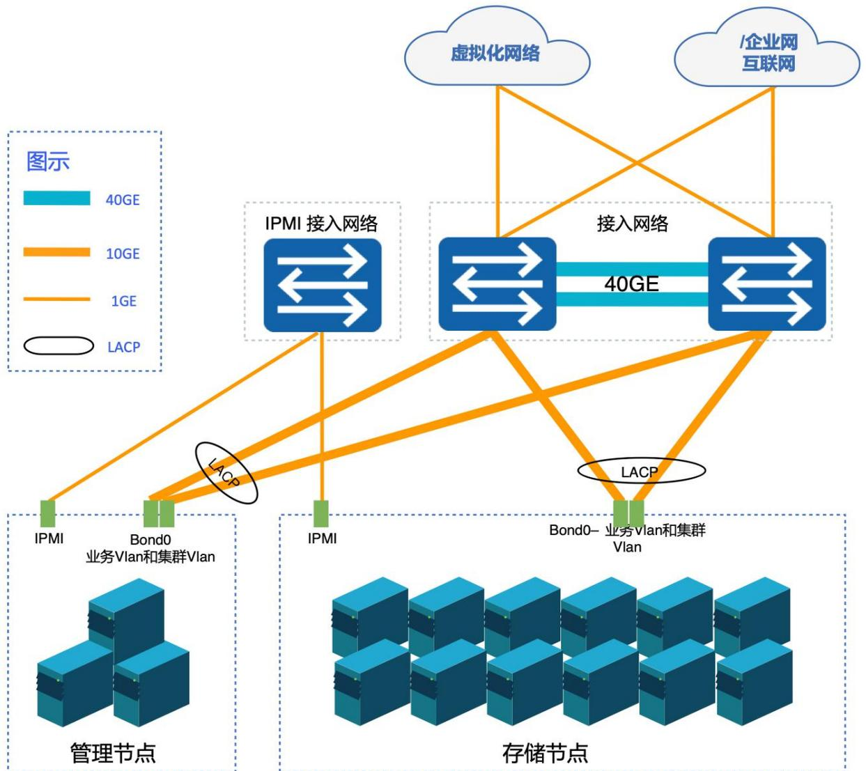
可采用 2 台万兆交换机堆叠，承载存储集群的所有网络流量，存储节点和管理节点服务器均使用 2 个接口绑定接入交换机 Trunk 接口，通过在服务器操作系统内划分 Vlan（即子接口）隔离业务网络和集群网络。管理节点同时接入业务网络和集群网络，为存储管理、业务接入、元数据读写等提供网络通信能力。
