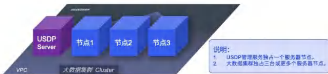
图 2-3 USDP 单集群多节点规划部署示意图
