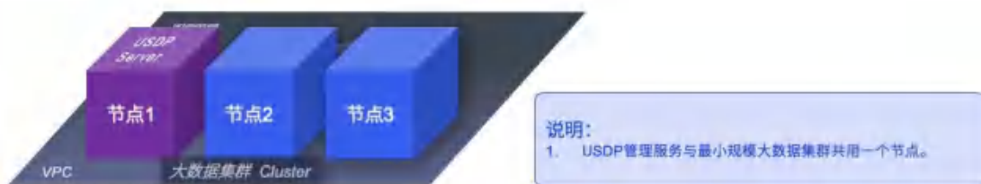
图 2-2 USDP 最小化规模部署示意图
